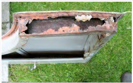
Gehäuse waren durchgerostet, mussten erneuert werden. Da auch die Federaufnahmen in der Karosse verrottet waren, wurden auch gleich die Federn ausgebaut und neu Gummigelagert.
